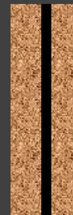
Dæmpning med 4 mm bitumenplader
