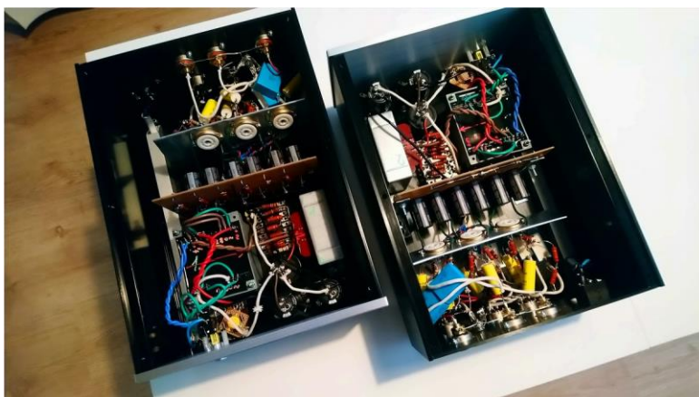
Her er bufferne montert, og de mangler kun rør. Legg merke til stjernejord i strømforsyningen, og felles stell til stellskrue på bakplaten.
