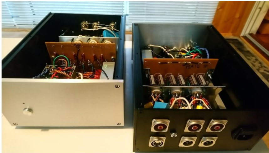
Strømbryter finnes på fronten. Ved "on" lyser en rød lysdiode diskre opp. Legg merke til felles stellskrue på bakplaten, mellom inn- og utganger.
