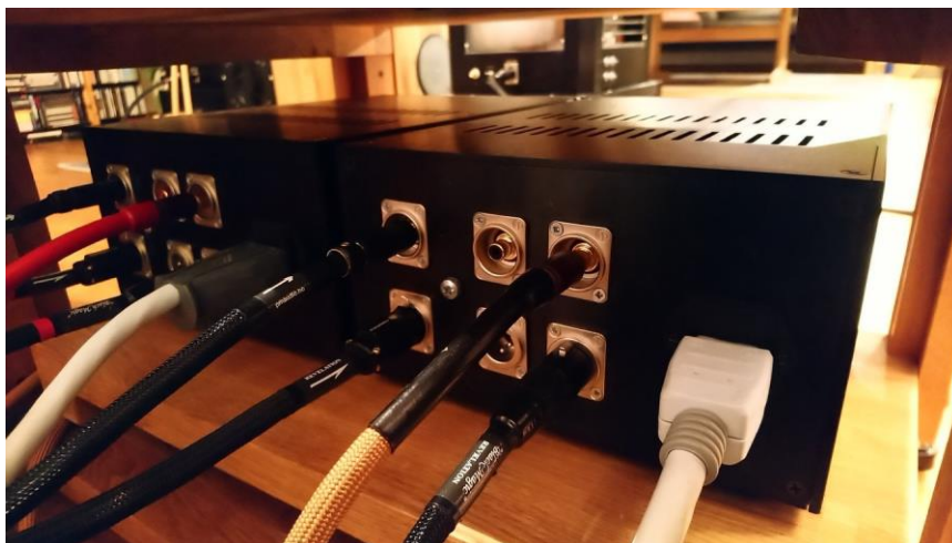
Bufferenes bakside med tilkoblet parallelle XLR- og RCA-signaler
