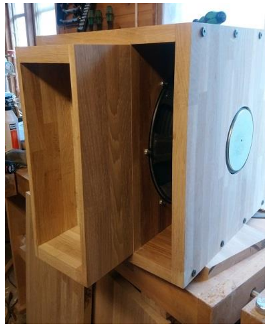
Her er baksiden med montert kasse til forsterkeren.
